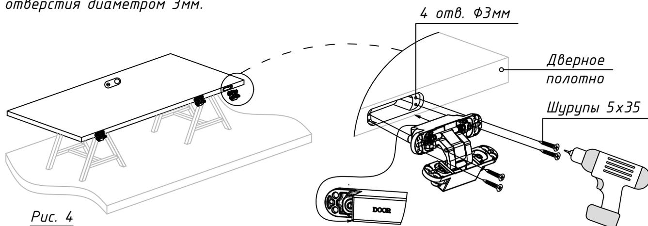
3.2. Установите дверное полотно с петлями в соответствующие пазы на дверной коробке, согласно маркировке, и зафиксируйте их шурупами 5x35 (см. рис. 5), предварительно просверлив отверстия диаметром 3мм.
